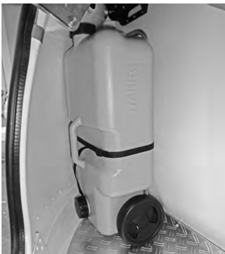
Abwassertank im Gasflaschenkasten
