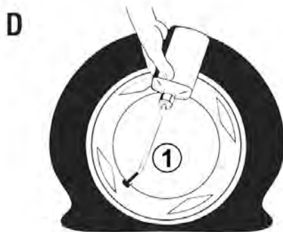
Flascheninhalt in den Reifen drücken
