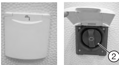
Einfüllstutzen für den Frischwassertank
