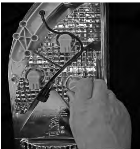
Leuchtmittel aus der Fassung drehen
