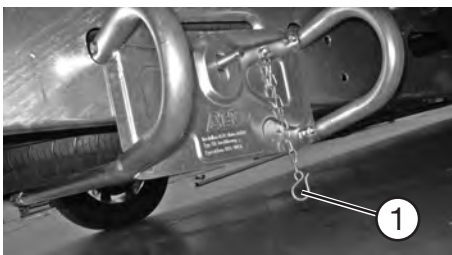
Schraubensicherung am Reserveradhalter
