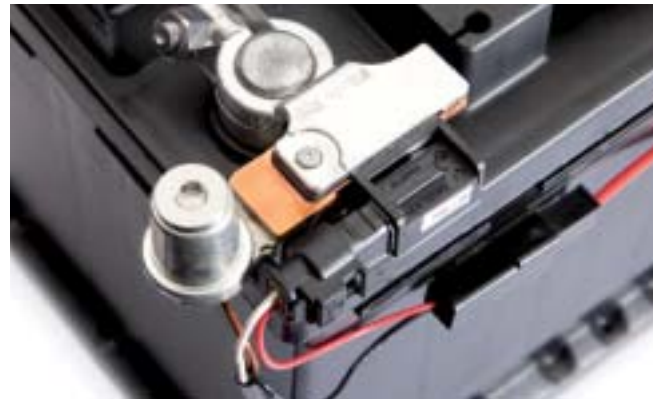
Montage am Standard-Batterie-Pol
