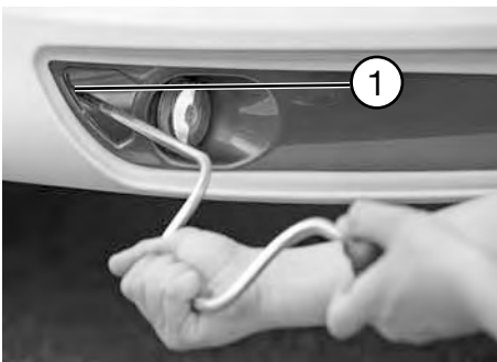
Sechskant für Ausdrehstützen vorne De Luxe (Edition)/Excellent/Prestige/Premium
