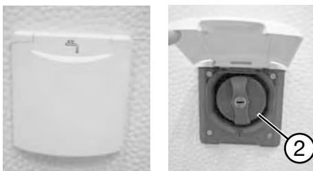
Einfüllstutzen für den Frischwassertank
