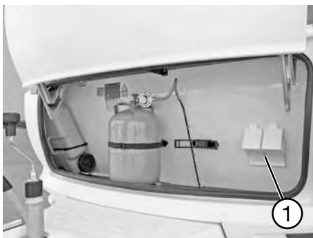
Unterlegkeile im Gasflaschenkasten
