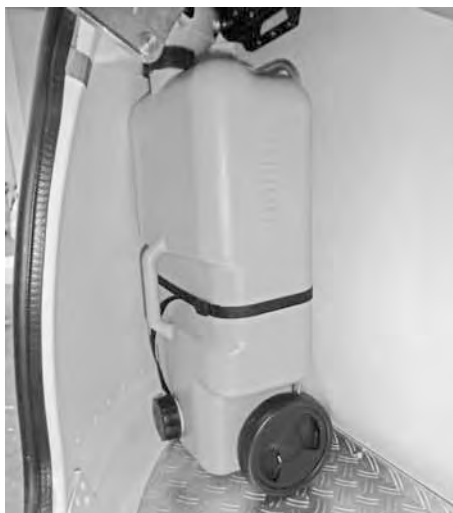
Abwassertank im Gasflaschenkasten
