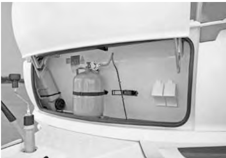
Positionierung der Gasflasche im Gasflaschenkasten
